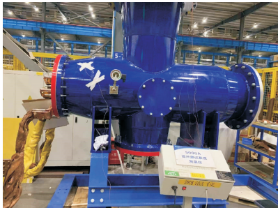
图 6 GIS 三工位开关温升测试装置 Fig. 6 GIS three-position switch temperature rise test device
